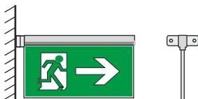
Τοποθέτηση κάθετα σε τοίχο με τη χρήση ειδικού πλαστικού εξαρτήματος που υπάρχει στη συσκευασία.
