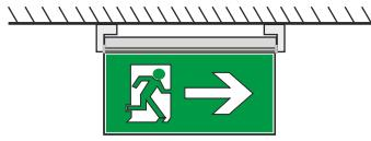
Τοποθέτηση στην οροφή με τη χρήση ειδικών πλαστικών εξαρτημάτων που υπάρχουν στη συσκευασία.
